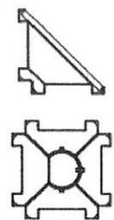
Le connessioni a 2/3/4 vie tra i moduli della parete sono gestite e con uno speciale gruppo snodato che permette la variabilità dell'angolo di unione da 90° a 180°, costituito da due profili tubolari in alluminio estruso anodizzato. È disponibile anche il modulo connessione 2 vie a 90° fisso realizzato mediante un profilo in alluminio comprensivo di un pannello in nobilitato melaminico o laccato con finitura come i pannelli di rivestimento della parete.
