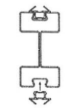
I montanti sono costituiti da un tubolare profilato in acciaio zincato sp. 8/10mm con sezione di 57\*30 mm, dotato di triplice cremagliera frontale a passo 32 mm con funzioni di sgancio pannelli ed accessori. Letteralmente ha un sistema di fori a passo 32 dedicati al fissaggio dei traversi orizzontali e ulteriori aperture ovali per il passaggio degli impianti. La sezione è a doppia camera tubolare chiusa al fine di garantire superiori prestazioni di resistenza al fuoco ed isolamento acustico.
